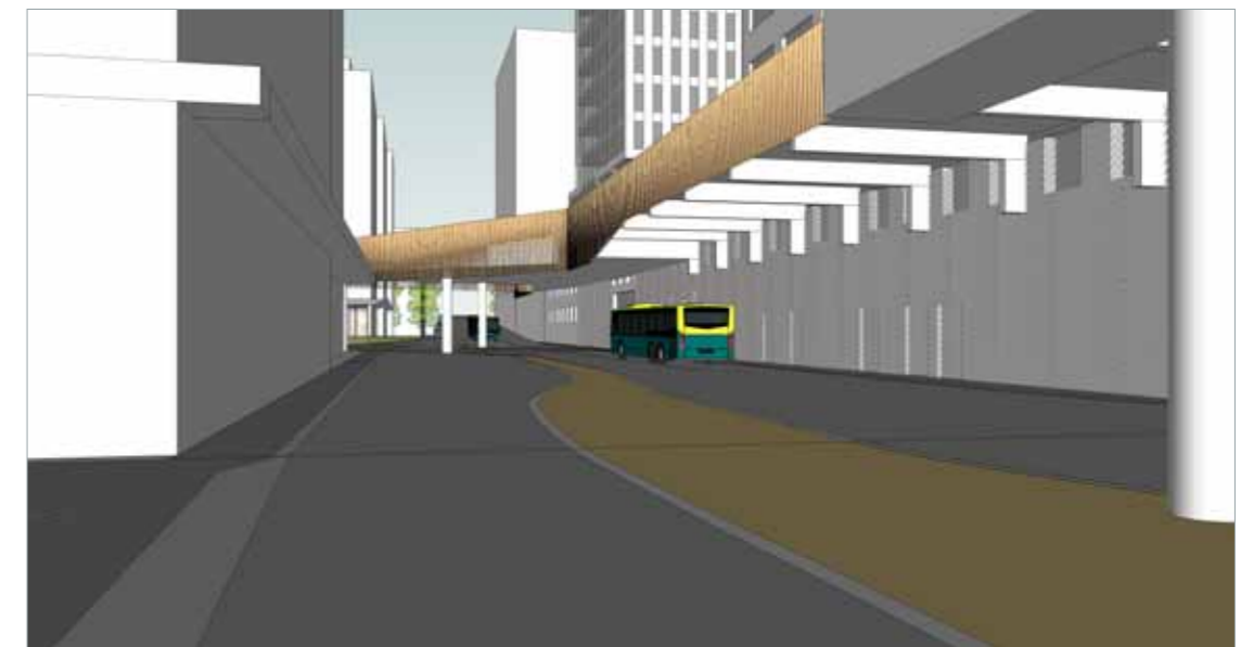
'loper' Noord is constructief 'opgehangen' aan het Stadskantoor
